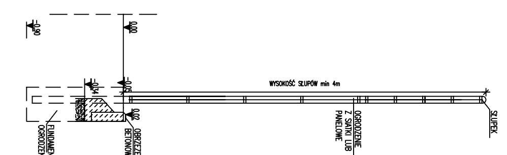
PRZEKRÓJ OGRODZENIA SKALA 1:20
